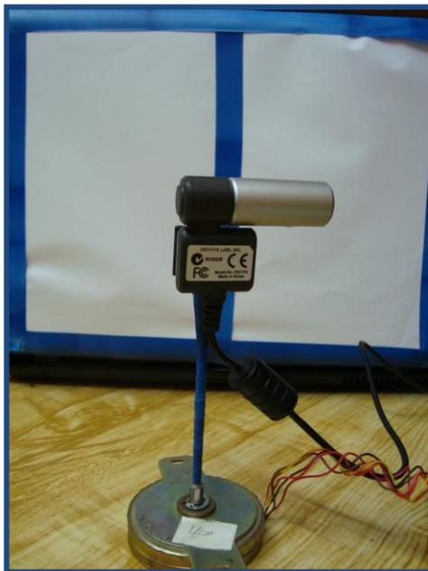
Fig. 14. Imagen del sistema funcionando; la web-cam apunta hacia donde se encuentra la línea.
