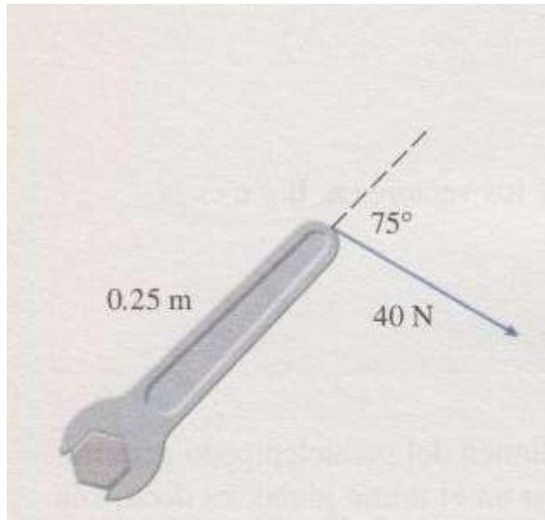
**EJEMPLO 6** Se aprieta un perno aplicando una fuerza de 40 N a una llave de 0.25 m como se muestra en la figura 5. Encuentre la magnitud del par de torsión respecto al centro del perno.
