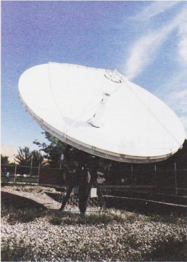
Una antena de disco refleja señales al foco de un paraboloide.
