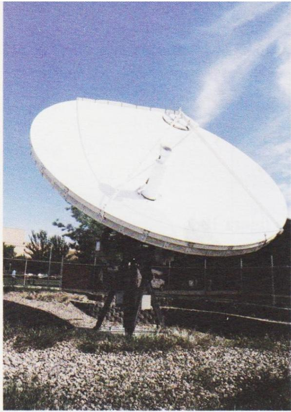
Una antena de disco refleja señales al foco de un parabolóide.
